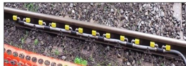
Elaborando i dati in uscita, è stato possibile fornire gli indici di qualità della ruota (IQR); sono stati analizzati i risultati e confrontati con un indice di qualità di una ruota in condizioni perfette, senza sfaccettature: è stato quindi possibile definire sue rette di IQR minimo e massimo, che definiscono 3 zone in cui l'IQR di una generica ruota può ricadere, e risultare ottima, accettabile o inaccettabile.
